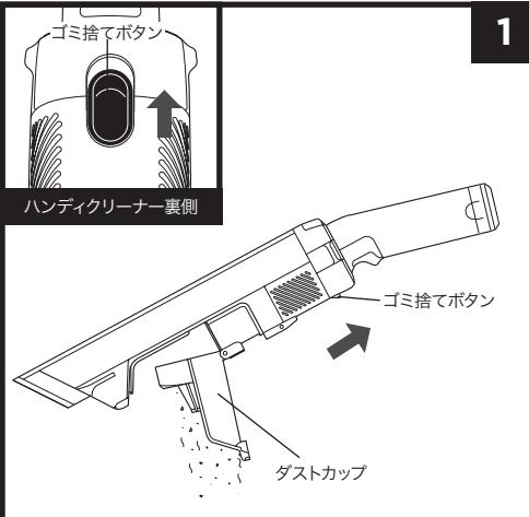
1. 電源がオフの状態で、ハンディクリーナー裏側のゴミ捨てボタンを手前にスライドさせると、ダストカップが開きます。
