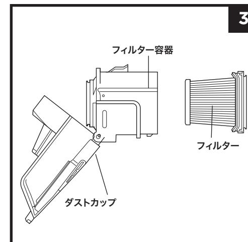
3. フィルター容器からフィルターを取り出します。フィルターは、水のみを使用して手洗いし、完全に乾いたことを確認してから取り付けてください。季節・環境により乾燥時間は異なります。フィルターが十分に乾いていない状態で使用すると、カビやにおい、故障の原因になります。
