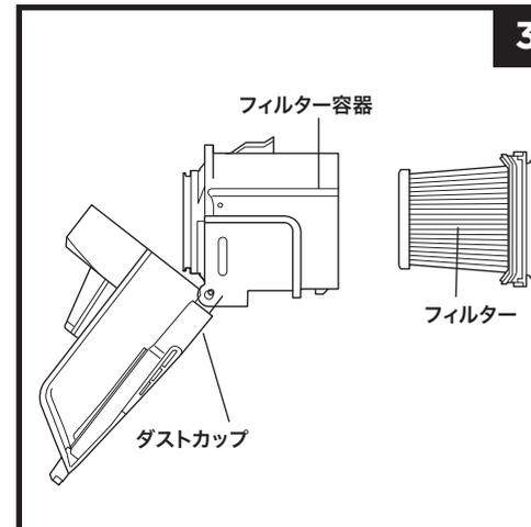
3. フィルター容器からフィルターを引き出します。フィルターは、水のみを使用して手洗いし、完全に乾いたことを確認してから取り付けてください。季節・環境により乾燥時間は異なります。フィルターが十分に乾いていない状態で使用すると、カビやにおい、故障の原因になります。
