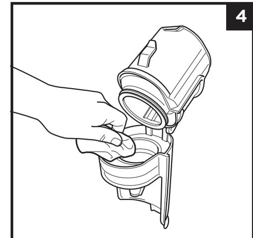
4. 取り外したダストカップは、水で洗うか湿らせた布で拭いてください。洗浄後は十分に自然乾燥させてください。
