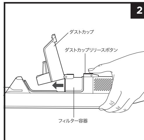
2. 電源がオフかつダストカップが開いた状態でダストカップ底部のダストカップリリースボタンを押し、フィルター容器を引き出します。
