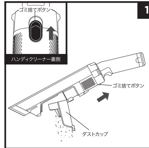
1. 電源がオフの状態、ハンディクリーナー裏側のゴミ捨てボタンを手前にスライドさせると、ダストカップが開きます。ダストカップにゴミが残っているとゴミが飛び散る場合がありますので、ゴミ箱の上にかざしてダストカップを開いてください。
