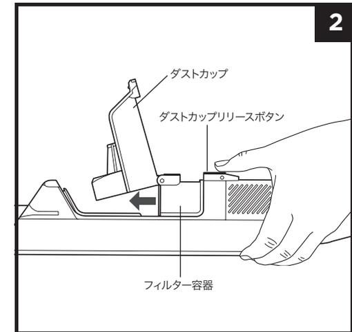
2. 電源がオフ、かつダストカップが開いた状態でダストカップ底部のダストカップリリースボタンを押し、フィルター容器を引き出します。
