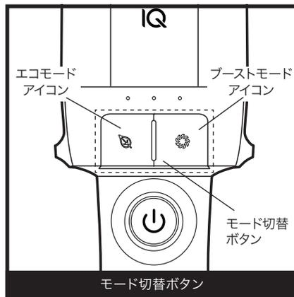
**ブーストモード:** より強力な吸引力を発揮するブーストモードに切り替えるには、ブーストモードのボタンを押します。ブーストモード時にはブーストモードのアイコンが点滅します。ボタンを再度押すとiQモードに戻ります。
