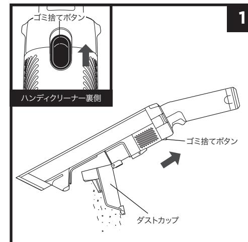
1. 電源がオフの状態で、ハンディクリーナー裏側のゴミ捨てボタンを手前にスライドさせると、ダストカップが開きます。ダストカップにゴミが残っているとゴミが飛び散る場合がありますので、ゴミ箱の上にかざしてダストカップを開いてください。
