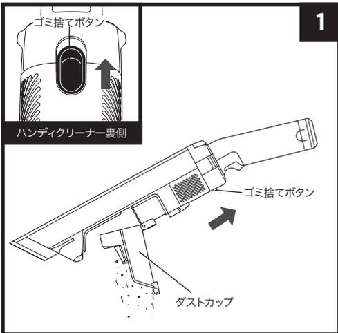
1. 電源がオフの状態、ハンディクリーナー裏側のゴミ捨てボタンを手前にスライドさせると、ダストカップが開きます。
