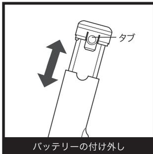
バッテリーをハンディクリーナーやバッテリー充電スロットから取り外す場合は、バッテリーのキャップ部の左右にあるタブを押しながら、バッテリーを引き出します。取り付けるにはバッテリーを元の位置に差し込みます。
